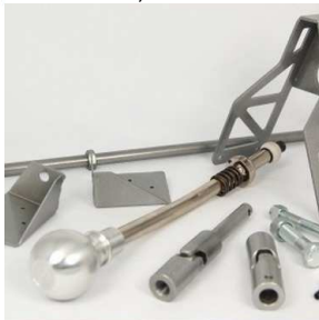
Rennschaltgestänge, erlaubt die Montage des Schaltgehäuses innerhalb des Fahrzeugs. Die Schaltstange wird mittels Spezialgelenken durch den oberen Teil des Mitteltunnels geführt. Preis ohne Standardstandschaltgehäuse € 451,50
