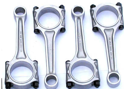
Erleichterte, feingewuchtete Pleuel für Hochleistungsmotoren, Pleuel wurden nach dem Polieren mit Stahlkugeln beschossen, um die Oberfläche zu verdichten.
