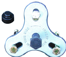
Schwungradabzieher Profiversion 3/8" und M10 mit Druckstück
