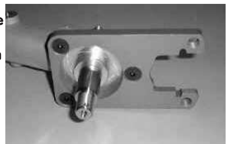
KAD-Aluschwinge hinten, reduziert die ungefederten Massen um einige Kilo Paarpreis
