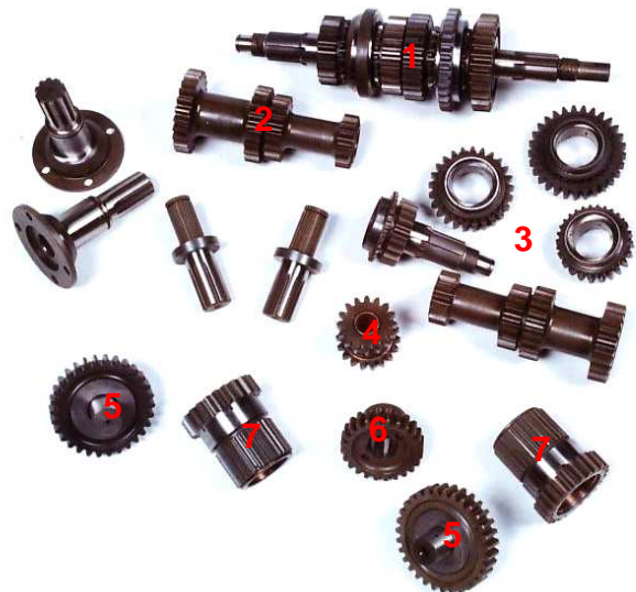
1 - Jack-Knight Hauptwellensatz für geradeverzahntes Synchrongetriebe; 2 - Vorgelege dazu; 3 - Zahnradsatz einzeln zu 1; 4 - Rückwärtsgangrad dazu; 5 - geradeverzahntes Zwischenrad; 6 - geradeverzahntes Getriebeeingangsrad; 7 - geradeverzahntes Primärrad;
