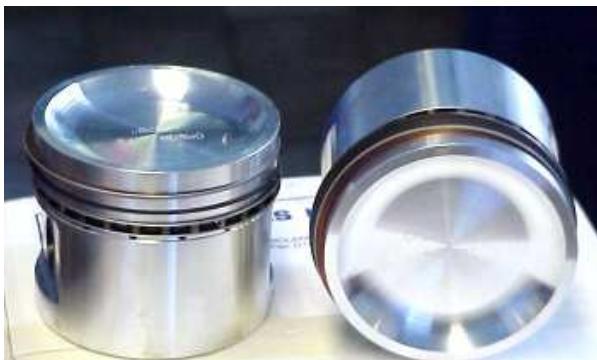
Omegakolben 0,20", speziell für leistungsgesteigerte Turbomotoren, wahlweise mit 11cc oder 18cc Mulde
