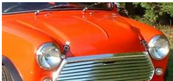
Die Twincam-Motorhaube aus GFK gibt zusätzlichen Platz oberhalb des Motors und für vorne montierte Vergaser sowie die Nockenwellenräder bei 16V-Motoren. Die Scharnierhalter sind in die Haube integriert. € 199,00
