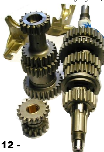
1 - Jack-Knight Hauptwellensatz für geradeverzahntes Synchrongetriebe; 2 - Vorgelege dazu; 3 - Zahnradsatz einzeln zu 1; 4 - Rückwärtsgangrad dazu; 5 - geradeverzahntes Zwischenrad; 6 - geradeverzahntes Getriebeeingangsrad; 7 - geradeverzahntes Primärrad;
