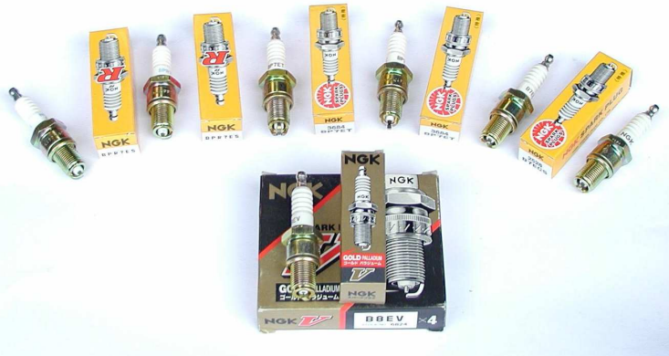
Von links nach rechts BPR7ES, entstörte Kerze für leicht getunte Motoren; BP7ET, Sonderkerze mit 3 Masseelektroden; BP7ECS, Sonderkerze für Turbomotoren; B8EV, oder B9EV, Rennkerze für stark getunte Motoren, verhindert auch das Nachzünden
