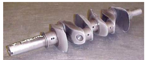
Extrem erleichterte Rennkurbelwelle für Mini-Miglia
