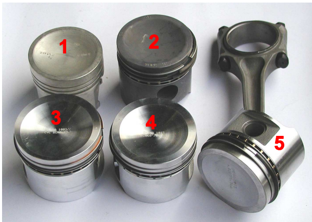
1 Hepolite Standard-Kolben 1.3i; 2 KS-Kolben mit niedriger Verdichtung; 3 Omega-Kolben 73,50 mit versetzter Mulde 11ccm; 4 Omega-Kolben 0,60" mit versetzter Mulde 7ccm; 5 Omegakolben 0,20" mit versetzter Mulde 7ccm auf erleichtertem Pleuel mit ARP-bolzen aufgezogen.
